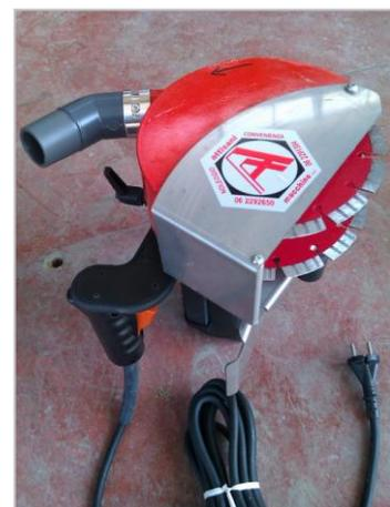
Lo scanalatore viene fornito dotato di 2 dischi  $\varnothing$  180 foro 22,2 mm, specifici per il taglio del cemento armato
