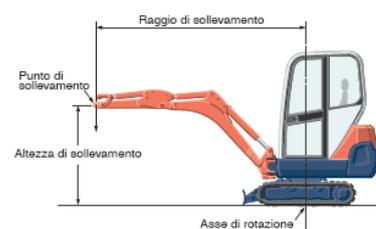
\* I dati sono forniti con benna standard Kubota, senza attacco rapido.
