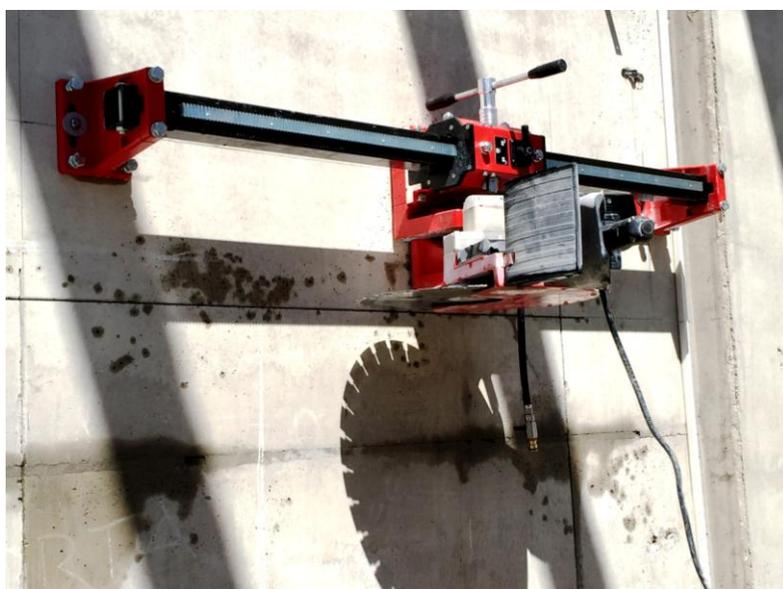
**Binario** composto da una colonna con cremagliera e slitta in alluminio dove è alloggiata la troncatrice, che scorre tramite un sistema a rulli. La colonna viene ancorata in maniera veloce e pratica ad apposite staffe che vengono stoppate alla parete.
