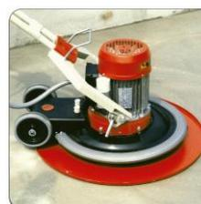
Dischi per la lisciatura di massetti cementizi
