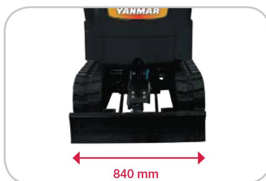
Con sottocarro aperto per aumentare la stabilità
