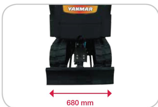
Con sottocarro chiuso per i passaggi più stretti
