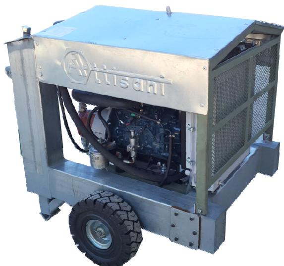
Centralina Idraulica professionale con motore Diesel da 20 Hp, raffreddato ad acqua.
